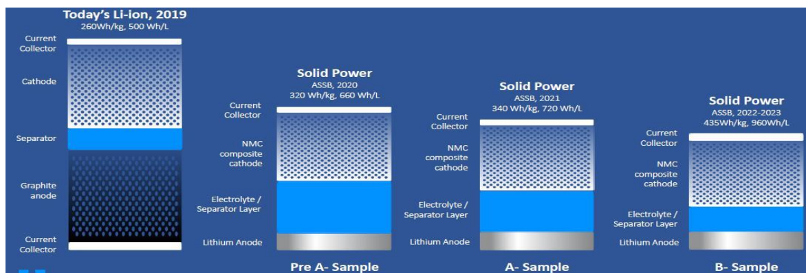
Figure 7 : Construction d'un élément Lithium tout solide (NMC : Nickel Manganese Cobalt)- Source Solid Power, 2020
