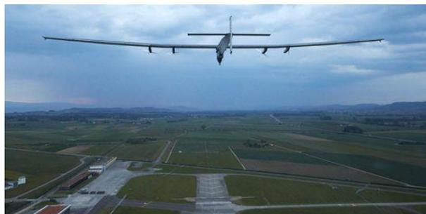
Figure 3 Le Solar Impulse nécessite une piste en dur d'au moins 45m de large, disponible uniquement sur les aéroports internationaux
